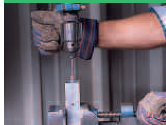
Sbavatura di una cavità con Tube Brush
