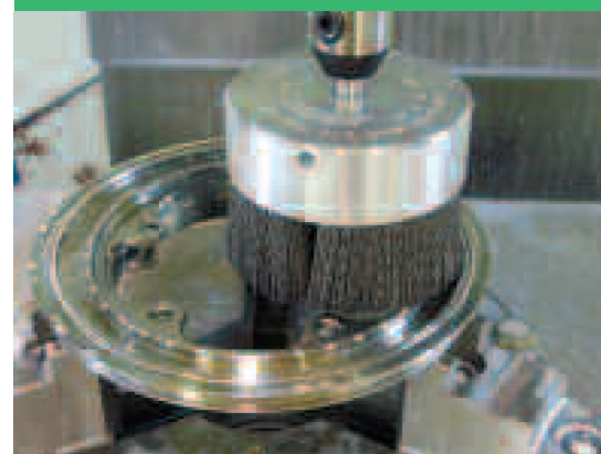
Rimozione di bave e spigoli vivi da Componente di trasmissione
