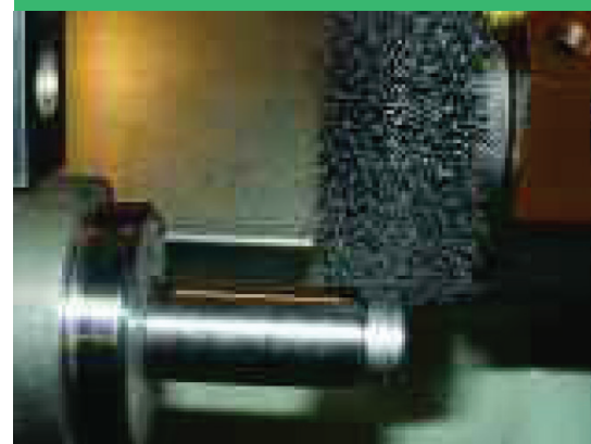
Sbavatura delle palette di una turbina di un motore di jet
