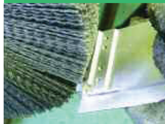
Sbavatura manuale di un componente in alluminio
