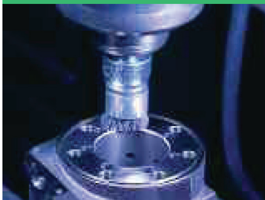
Rimozione segni di utensile da componente idraulico
